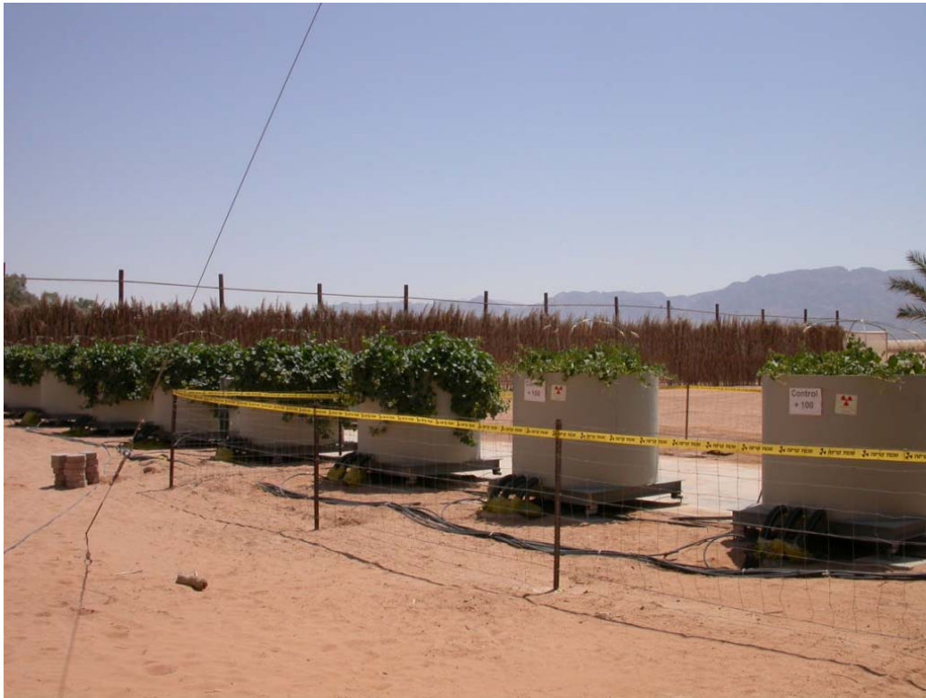
איור מס' 1: מבט על מערך תשעת הליזימטרים בהם גדלים צמחי המלון.
