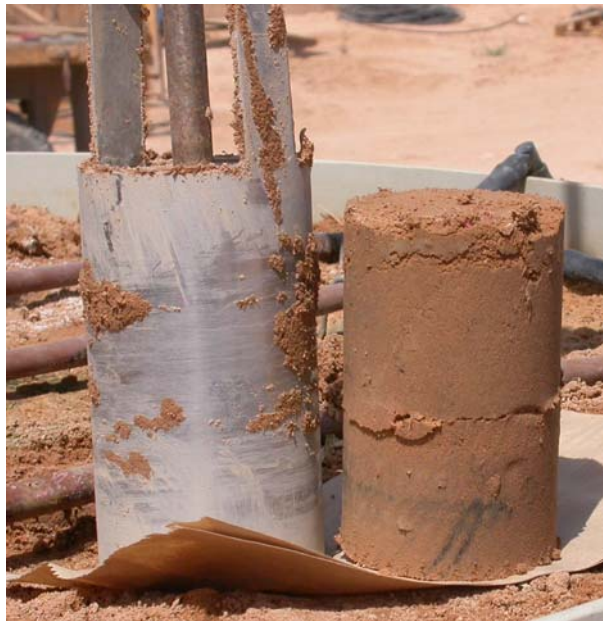
תמונה 2: מקדח הקרקע ודוגמת הקרקע שנדגמה באמצעותו.
