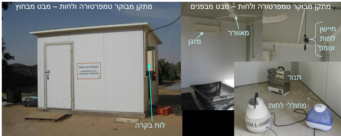
תמונה מס. 1 : מתקן הבחלה מבוקר טמפרטורה ולחות.
