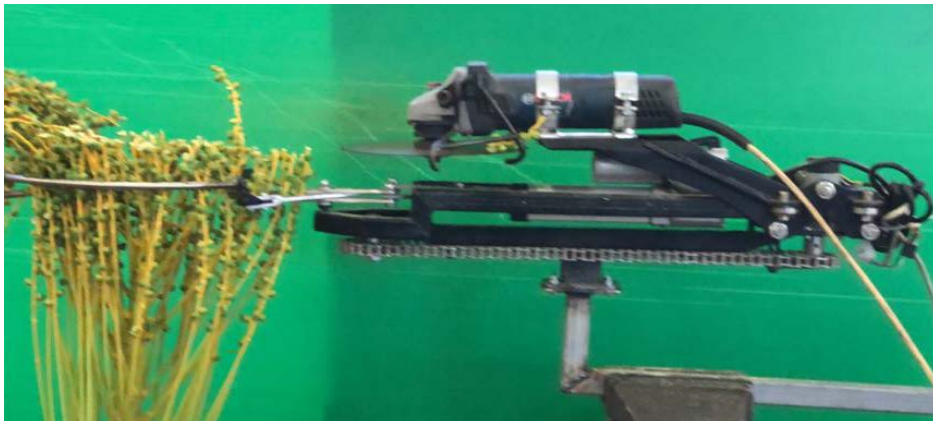
איור 7: ניסוי במערכת אלקטרו מכנית עם הפעלה מרחוק במעבדה עם דיסק במצב מאונך ובמצב מאוזן.
