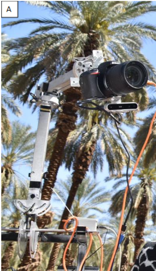
איור 16: מתקן החזקת הציוד (מצלמת SDLR, RGBD, וחיישן מרחק ליזר). A, B. מתקן ראשוני עם הרבה דרגות חופש שנמצא מורכב מדי עבור צילום ברום העץ. C. מתקן ידני.
