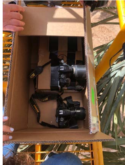
איור 18: מימין שתי המצלמות ממוקמות באלכסון אחת לשני בתוך מעמד. משמאל המעמד על מתקן הגובה במו"פ ערבה דרום במהלך הצילומים.
