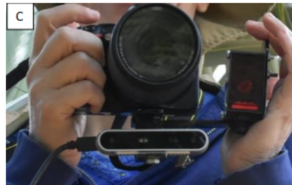
איור 16: מתקן החזקת הציוד (מצלמת SDLR, RGBD, וחיישן מרחק ליזר). A, B. מתקן ראשוני עם הרבה דרגות חופש שנמצא מורכב מדי עבור צילום ברום העץ. C. מתקן ידני.
