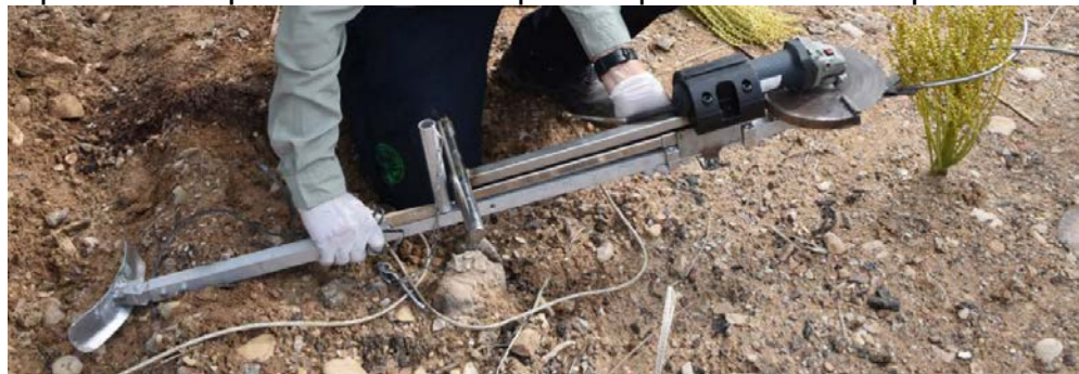
איור 3: חובק עם מערכת צבתות ומסור דיסק בקוטר 7".
