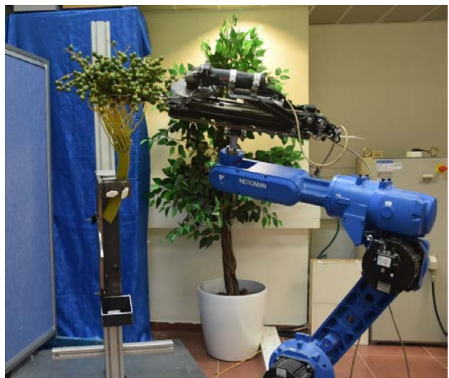
איור 8: מערכת חיתוך אלקטרו-מכאנית, עם שליטה מרחוק, מורכבת על רובוט MOTOMAN במעבדת רובוטיקה באוניברסיטת בן גוריון (אצל מעבדת פרופ' סיגל ברמן).
