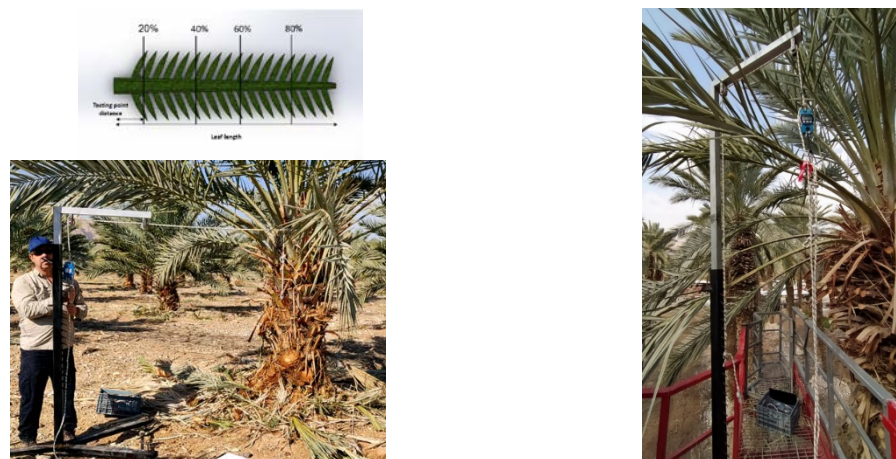
איור 42: נקודות עיגון העלה למדידת כוחות ומערכת הניסוי במטע.
