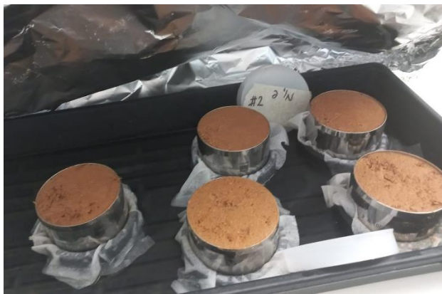
איור 2 - דיגום קרקע מקומית ליד העצים במו"פ ערבה דרומית. הדגימות קרקע לא מופרות לצורך בדיקת הייפרופ. בתמונה מצד שמאל - הרטבת הדוגמאות לפני הבדיקה.
